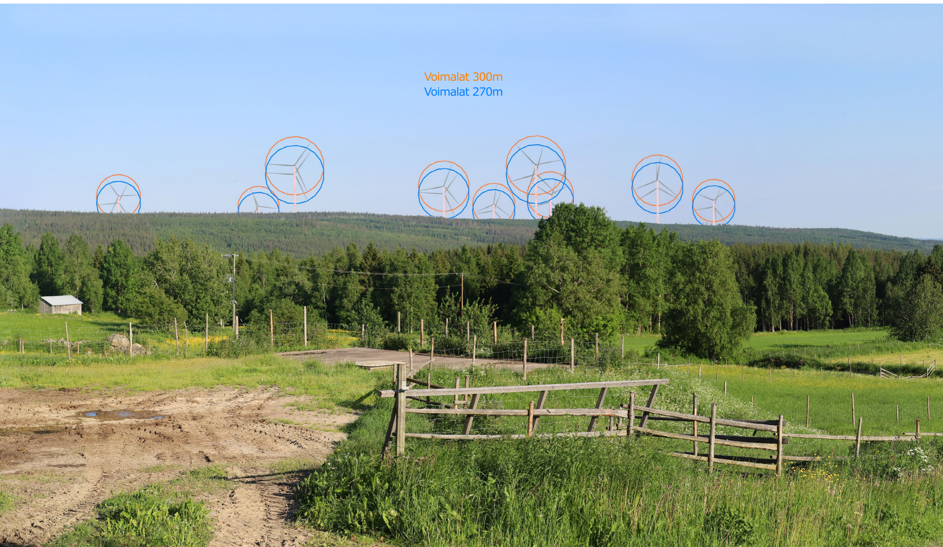
Voimalakokojen vertailu: Kokonaiskorkeus 300 m ja 270 m, molemmissa roottorin halkaisija 200 m. Kuvasaikka 2 Latvan kylä.
